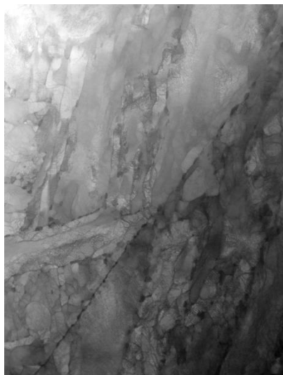
1.2. attēls. Martensīta tērauda TEM attēls (12.1 \mu m ).
