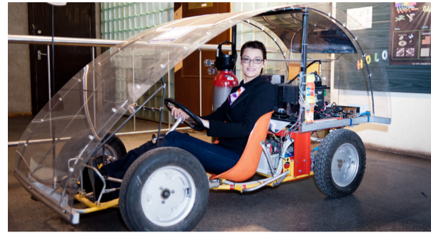
Iespējams, pasaulē vienīgais ar ūdeņraža gāzi darbināms elektrokartings, kas izgatavots LU CFI sadarbībā ar RTU EVIF. Šobrīd vairs nepastāv, tomēr ar šo elektroauto, iespējams, ir izbraukuši daudz vairāk Latvijas iedzīvotāju, nekā ar istu. Foto: M. Morkāns. 2012. gads.
